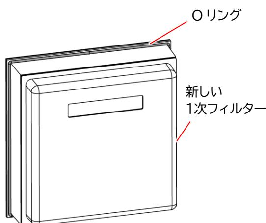
5. 新しい1次フィルターのREMOVEステッカーをはがします。
