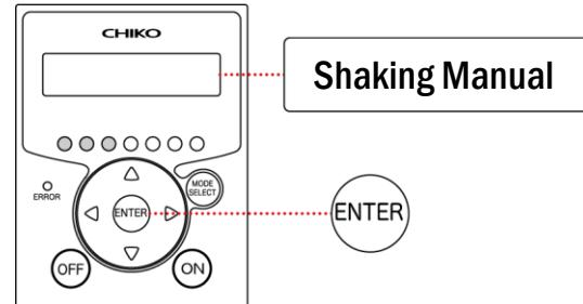
4. ディスプレーに「Shaking Start Y」が表示されていることを確認し、[ENTER]を押します。
