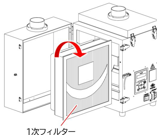
4. 新しい1次フィルターにOリングが取り付けられていることを確認します。
