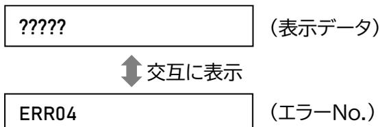
2. MODE SELECTボタンを押し、エラー履歴モードに移行します。複数のエラー・警告が発生しているときは、エラーNo.の左側に件数が表示されます。
