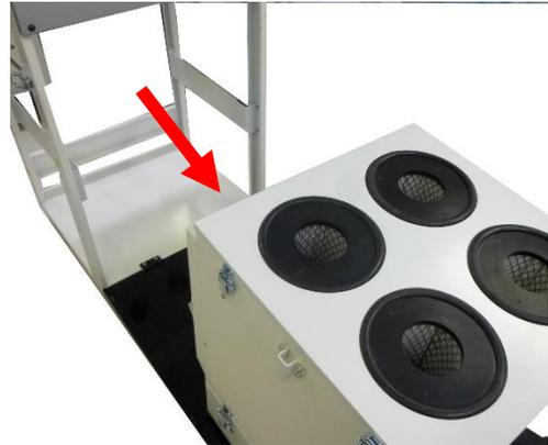
5. 4か所のキャッチクリップをし、フィルター押え板を外します。
