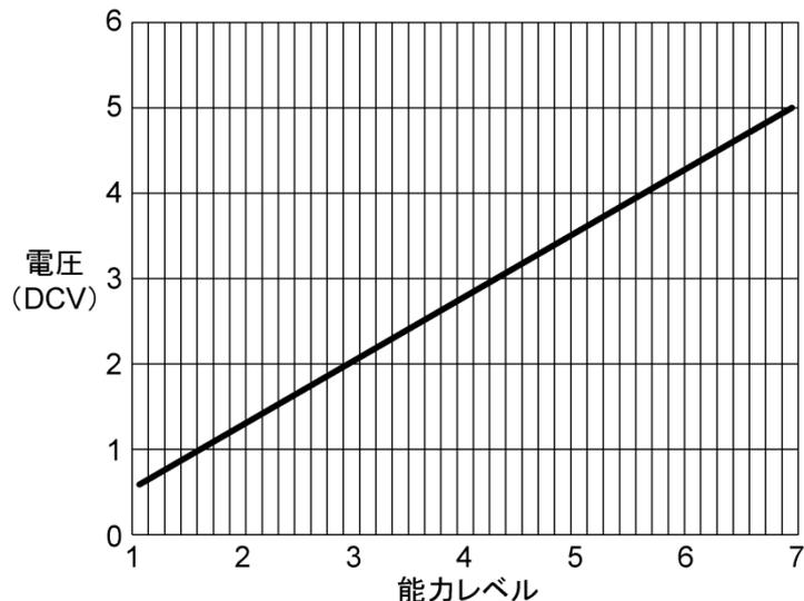
誤差が±4%あるため、電圧を設定する場合は、各レベルの midpoint の電圧を印加してください。
