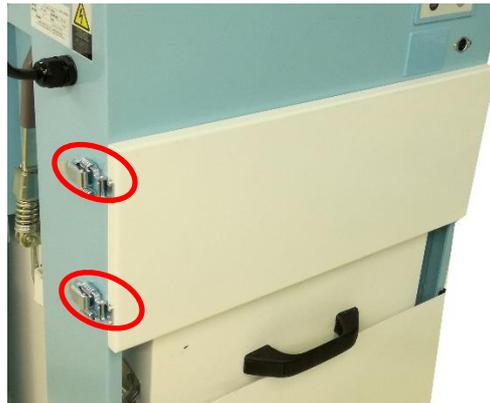
2. フィルタ脱落防止用板金のネジを外す。
