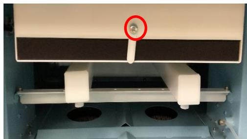
3. 下側よりプリーツを掴み、フィルタを外して交換して下さい。
