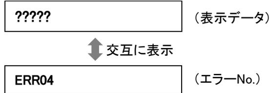
2. MODE SELECT ボタンを押し、エラー履歴モードに移行します。
