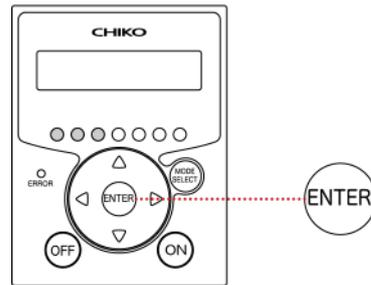
3. ディスプレイに「Initial DP Get Y」と表示されたら[ENTER]を押します。初期圧の取得動作が開始します。登録が完了するまで、待機してください。
