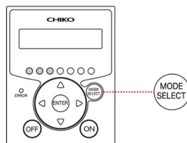
6. ディスプレーに「ERROR CLEAR Y」と表示されたら[ENTER]を押します。
