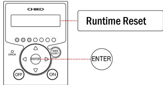
4. ディスプレーに「Reset Runtime Y」と表示されたら[ENTER]を押します。
