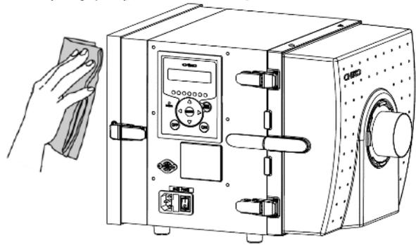
2. パッチン錠を解除し、吸気側フィルター室を開きます。
