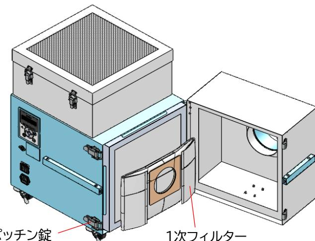
3. 新しい1次フィルターを取り付け、吸気側フィルター室を閉じ、パッキン錠で固定します。
