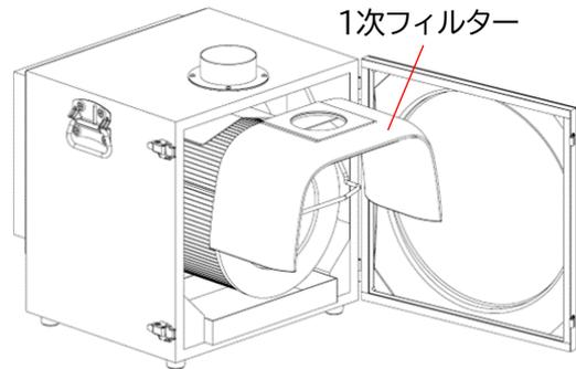
4. 新しい1次フィルターのパッキンを円筒パイプにしっかり押し込み、元通りに取り付けます。
