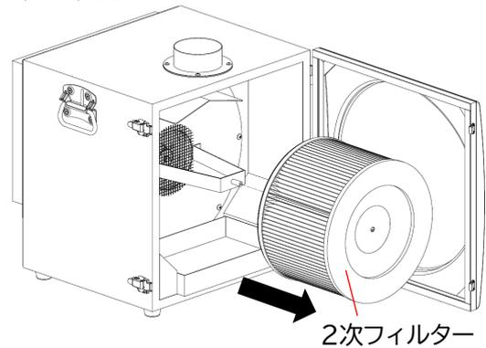
5. 新しい2次フィルターを取り付け、1次フィルターも元通りに取り付けます。
