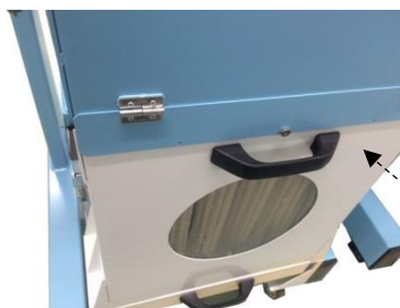
1次フィルタ室
